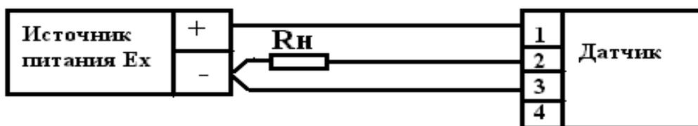
Схема соединений датчика с искробезопасным блоком питания
