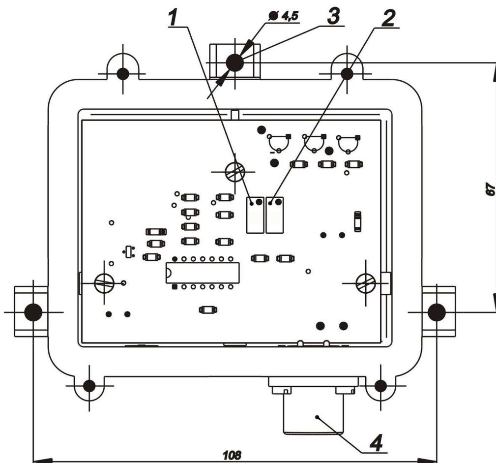
Рис. 2. Датчик в силуминовом корпусе со снятой крышкой
