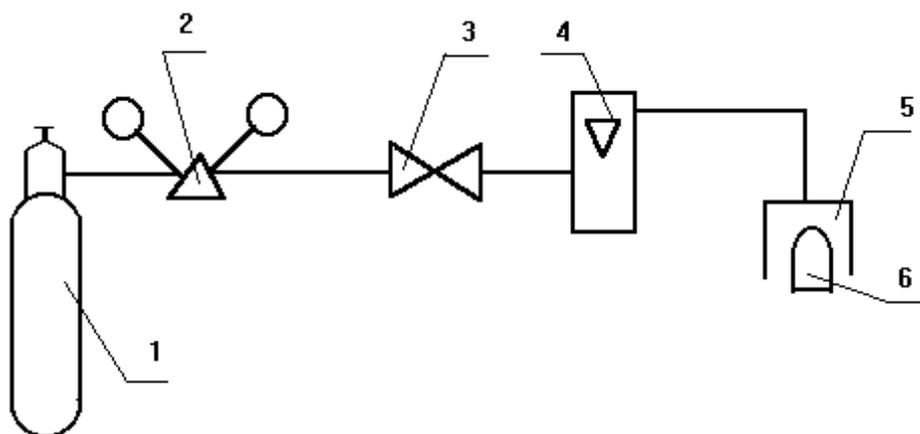
1. Баллон с ПГС; 2. Редуктор; 3. Вентиль точной регулировки;
