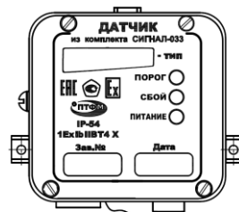
Рис. 3 Датчик МИГ-ЭЛ, МИГ-ОП в силовом корпусе
