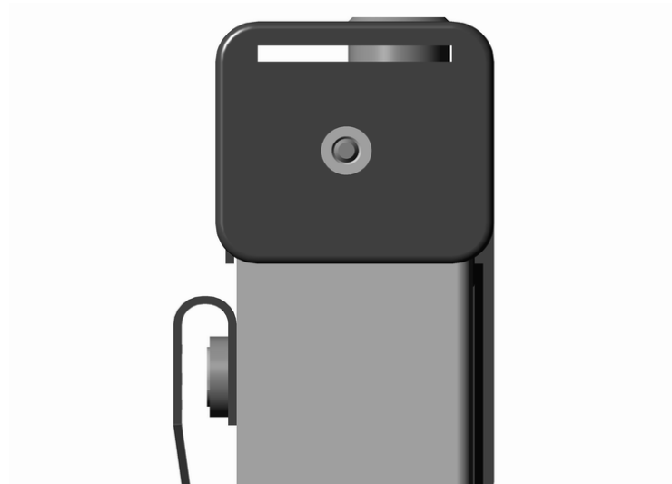
Рис.4. Расположение гайки, закрывающей доступ к регулировочным потенциометрам
