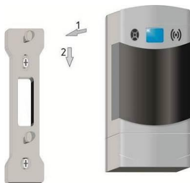
Рисунок 3 – Установка сигнализатора на монтажную панель
