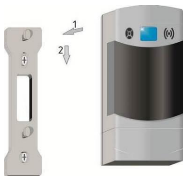
Рисунок 3 – Установка сигнализатора на монтажную панель
