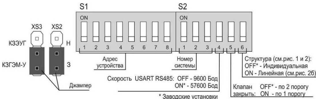
Рисунок 4 – Назначение переключателей и перемычек.
