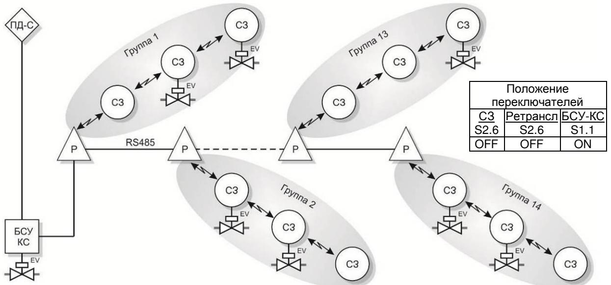
а) линейная с ретрансляторами. Количество и места подключения клапанов показаны условно и определяются требованиями заказчика.
