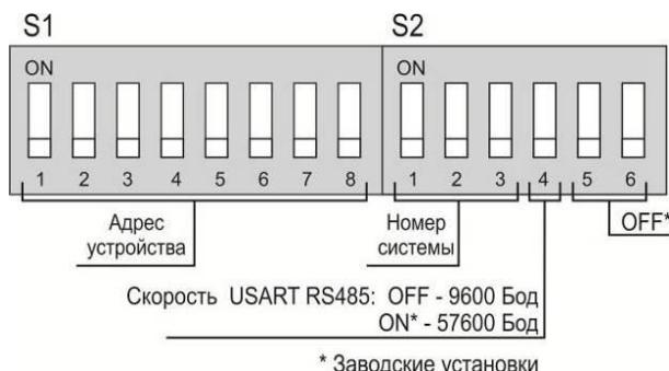
Рисунок 16 – Ретранслятора P-433. Расположение переключателей.
