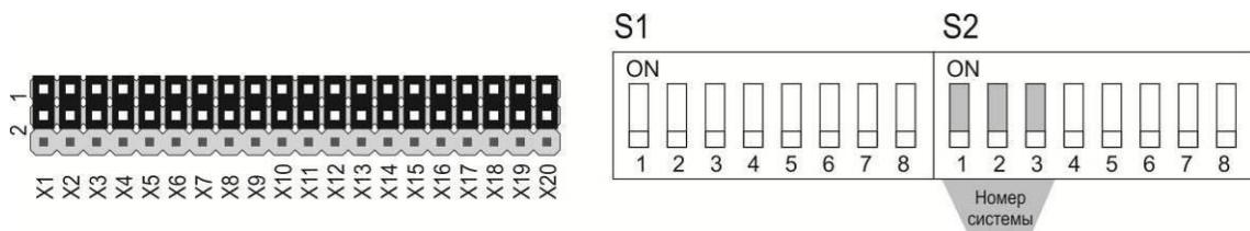
Рисунок 13 – БСУ-КС. Расположение перемычек и переключателей
