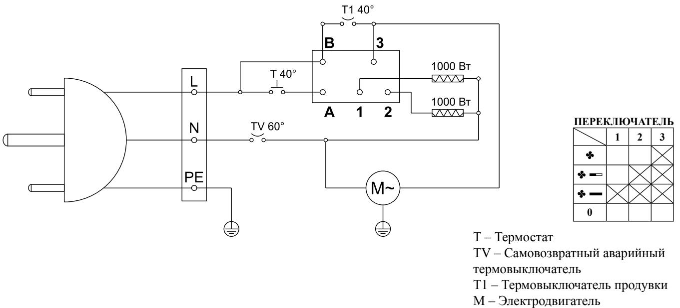
Рисунок 4. Электрическая схема тепловентилятора КЭВ-3С31Е
