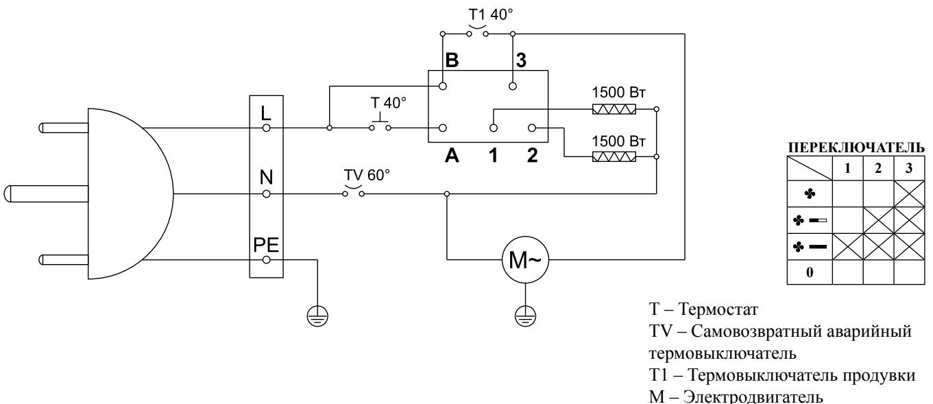
Рисунок 5. Электрическая схема тепловентилятора КЭВ-2С41Е
