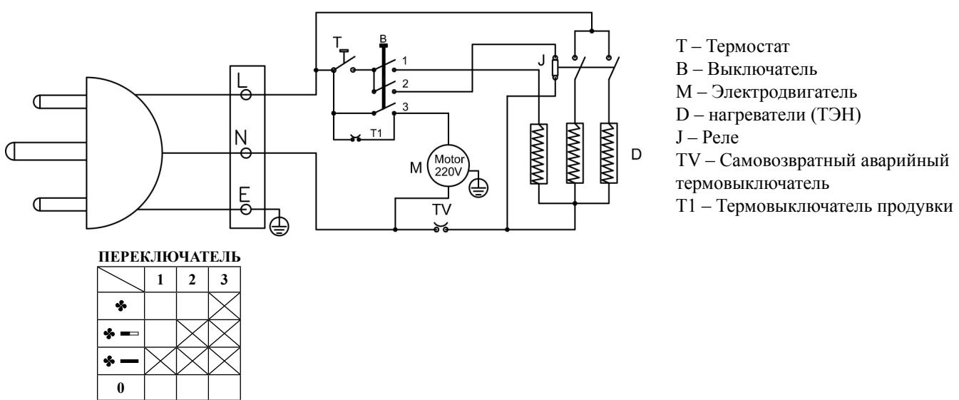
Рисунок 8. Электрическая схема тепловентилятора КЭВ-6С41Е
