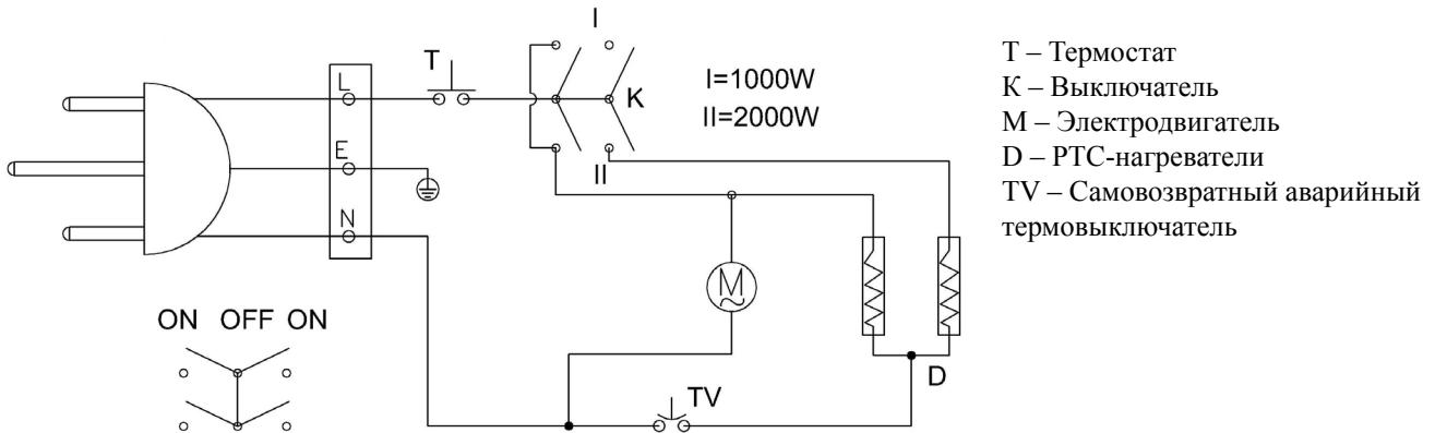
Рисунок 3. Электрическая схема тепловентилятора КЭВ-2С31Е
