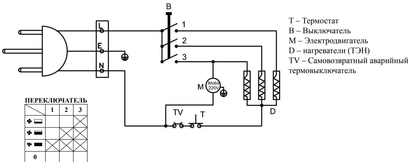
Рисунок 6. Электрическая схема тепловентилятора КЭВ-3С41Е
