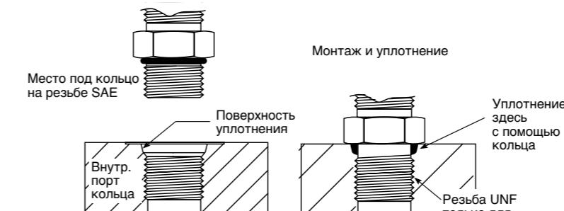
Уплотнение и монтаж - это не две разные функции в резьбовых соединениях SAE.
